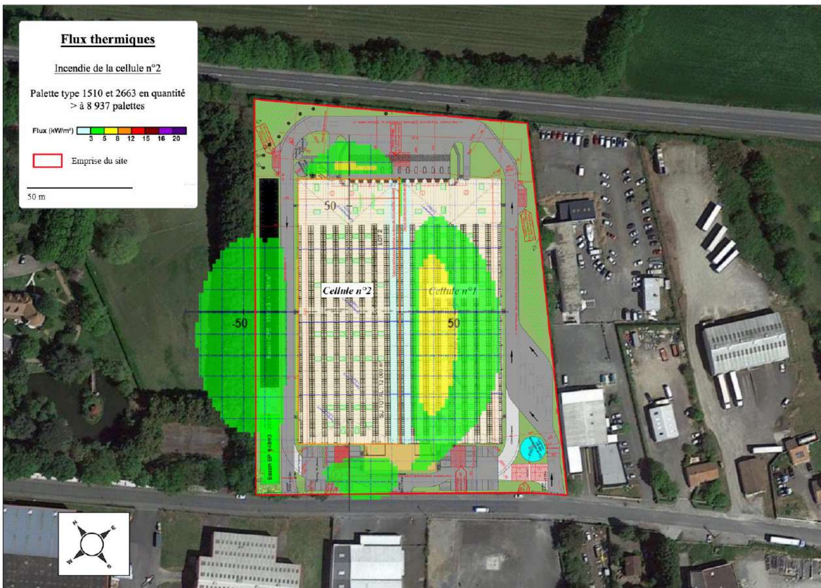
Figure 9 : Flux thermiques de la cellule n°2 avec palette type 2663 dans des quantités supérieures à 8 937 palettes (application des restrictions de stockage)
