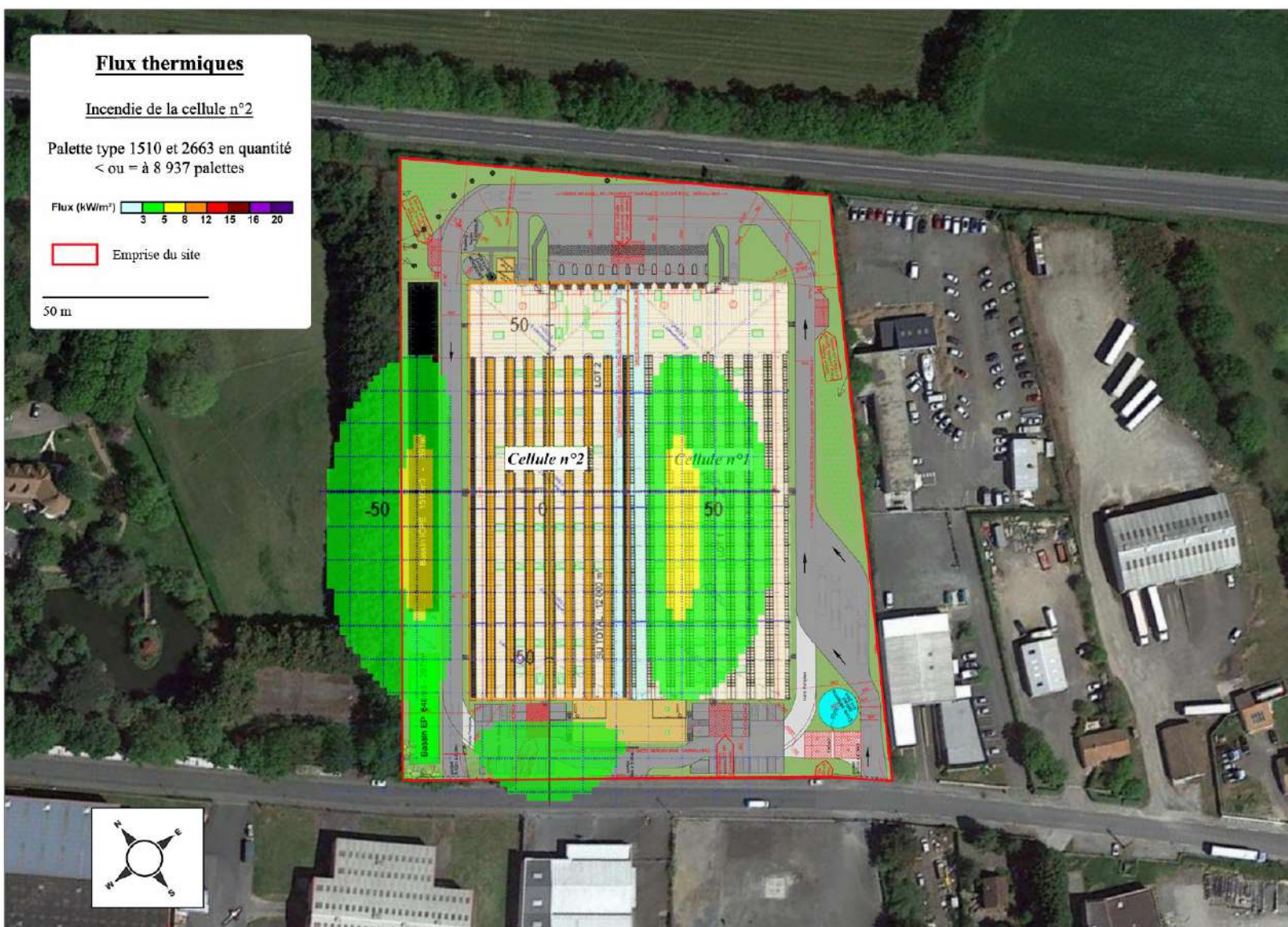
Figure 11 : Flux thermiques de la cellule n°2 avec palette type 1510 et 2663 dans des quantités inférieures ou égales à 8 937 palettes
